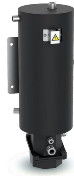
Calentador de paso instantáneo para agua, con resistencias blindadas Incoloy 825. Limitador de seguridad integrado. Aislamiento de espuma externo.
