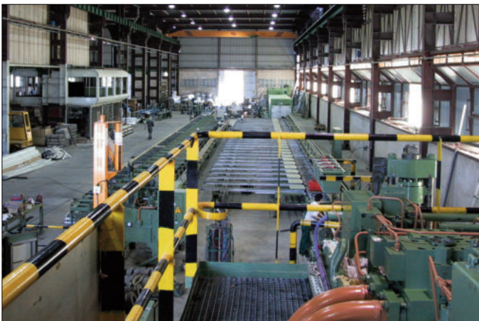
Prensa SCHLOEMANN de 2.000 Tn de potencia. Presse SCHLOEMANN de 2.000 Tn puissance. SCHLOEMANN press de 2.000 Tn power.
