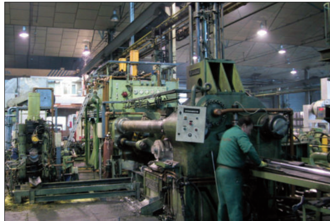
Prensa OLIVARTÉS de 1.600 Tn de potencia. Presse OLIVARTÉS de 1.600 Tn puissance. OLIVARTÉS press de 1.600 Tn power.
